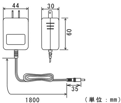
(中継機に限り 2019年1月出荷分より、12V スwitching式 AC アダプタが付属されています。)
